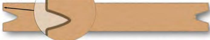
Durch eine zusätzliche Ummantelung sind die Dielen besonders widerstandsfähig gegenüber äußeren Einflüssen wie UV-Strahlung und Feuchtigkeit.
